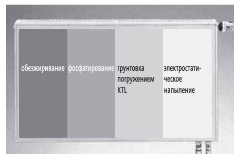
Подготовка поверхности радиатора
